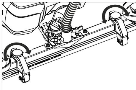
→ Mēģiniet regulēt augstuma regulēšanas grozāmrokturus, līdz ir panākts vislabākais sūkšanas rezultāts.
