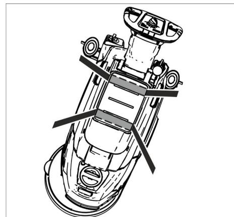
→ Kun kuljetat laitetta ajoneuvoissa, varmista laite liukumisen ja kaatumisen varalta kulloinkin voimassa olevien ohje-sääntöjen mukaisesti.
