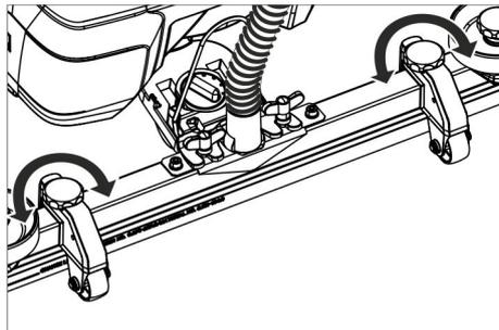
→ Zkuste nastavit výšku pomocí otočných rukojetí, tak aby bylo dosaženo nejlepšího sacího účinku.
