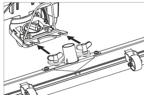
➔ Montați furtunul de aspirație.
