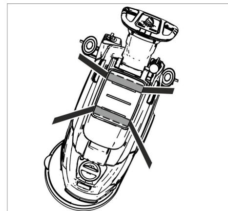
→ Při přepravě v dopravních prostředcích zajistěte zařízení proti skluzu a překlopení podle platných předpisů.
