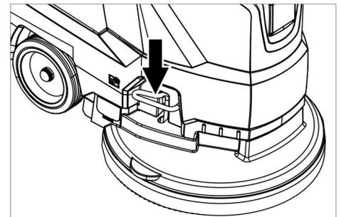
→ Gerät nach hinten wegziehen, damit die Scheibenbürste zugänglich wird.
