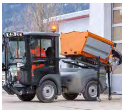
MC 130, hidravlično praznjenje z višine
